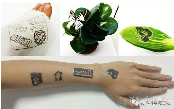
图 1. 贴覆于人体与物体表面的定制化石墨烯纹身
